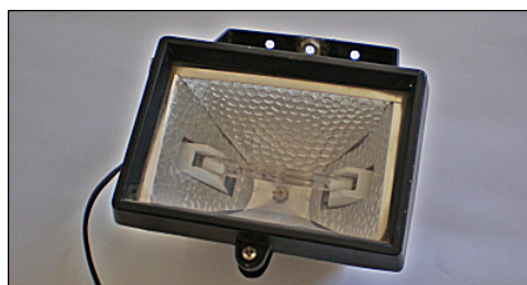
Foco halógeno de 150 watts utilizado para el fotograbado de matrices pequeñas
