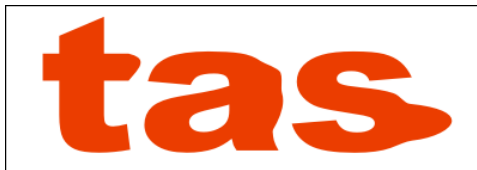
Defecto producido por una tinta demasiado líquida
