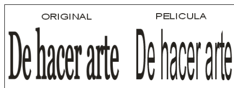
Discrepancias entre las fuentes del diseño y las fuentes de la película
