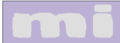
Subexposición que provoca ensanchamiento de la imagen e la matriz
