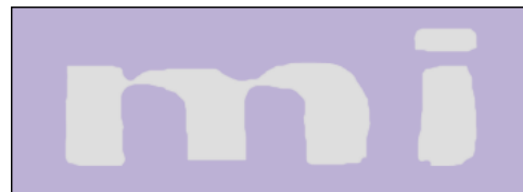
Sobreexposición que provoca adelgazamiento de la imagen en la matriz
