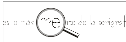
Detalles y líneas finas no aparecen en la película de proceso fotográfico
