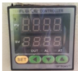
Figura 16. Control de temperatura
