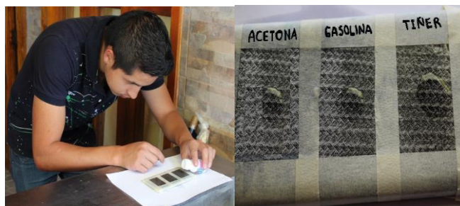
Figura 44. Prueba a base de compuestos químicos sin protección
