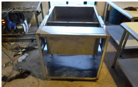
Figura 32. Instalación del tanque dentro del mueble
