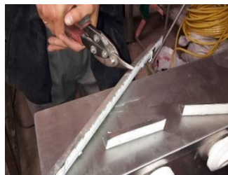
Figura 34. Adaptación de los soportes de las mallas
