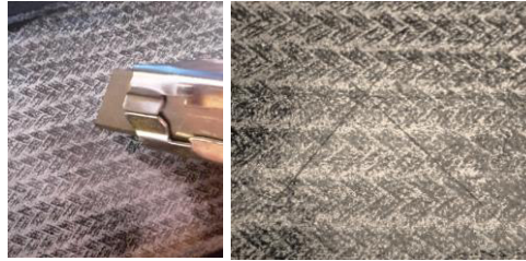
Figura 45. Corte en X sobre el área WTP
