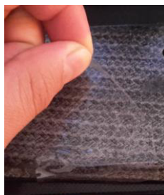
Figura 48. Retirar la cinta para revisar resultados de adherencia
