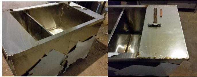
Figura 33. Recubrimiento total del mueble del tanque
