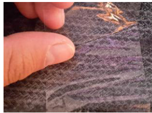
Figura 46. Aplicación de la cinta adhesiva sobre el corte en X
