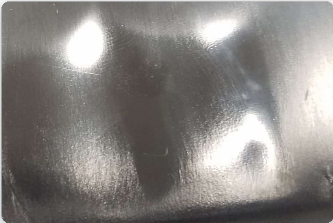
Ejemplo de pieza con marcas de hundimiento
