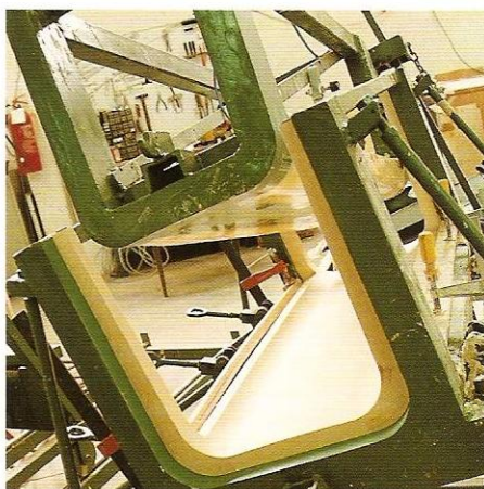
4 Unas prensas dan forma a la madera contrachapada que reviste el armazón de la mesa.
