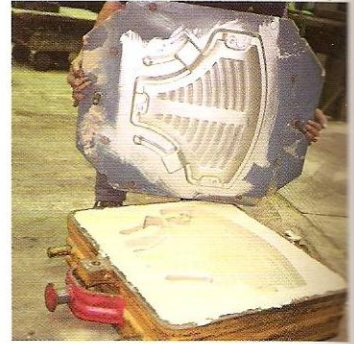
3 Se separa la pieza junto con el molde superior. Ahora está lista para el acabado.
