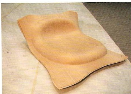
4 El asiento está listo para adquirir su forma definitiva. Sólo falta recortar el material sobrante alrededor de la pieza.
