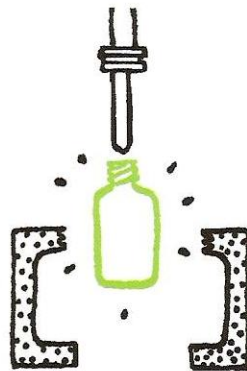
3 Se abre el molde y se libera la pieza.
