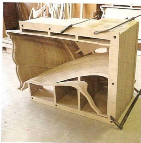
2 Vista de la estructura interna mecanizada antes de proceder al cortado de la superficie externa.
