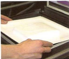
4 Se aplica un vacío a fin de obtener la forma.
