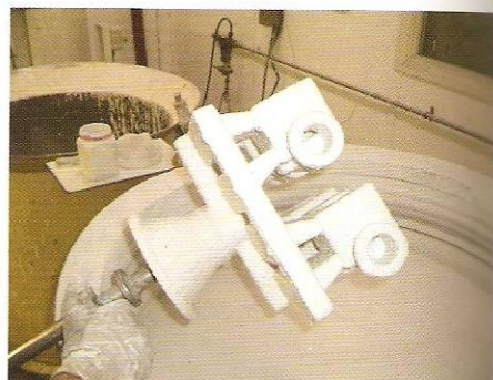
2 Esta imagen, en la que aparece un patrón distinto, muestra un conjunto sencillo de cuatro productos a punto de sumergirse en el barro cerámico.
