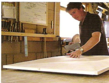
3 El acabado del panel moldeado.
