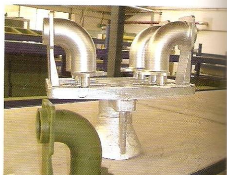
6 La imagen muestra un producto final junto a su modelo original en cera.
