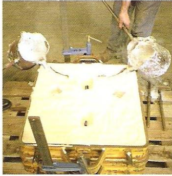
2 Se vierte metal fundido en los canales de colada.
