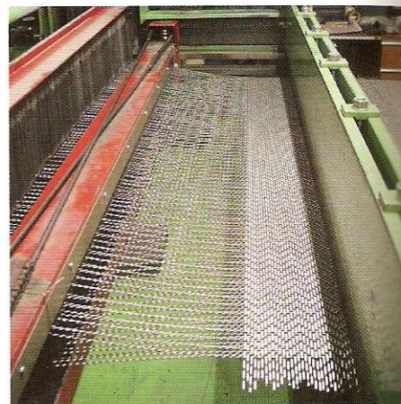
4 Empiezan a formarse las piezas de malla metálica que se usarán como componente arquitectónico.
