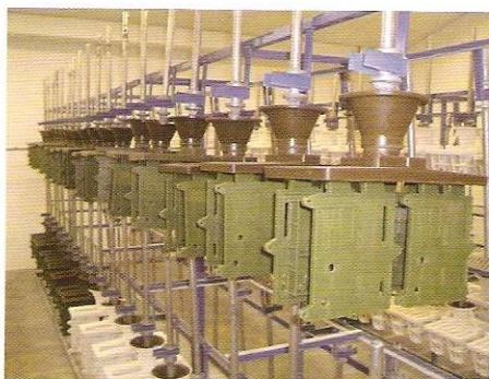
3 Dispositivo habitual de producción en el que aparecen una serie de productos de cera montados en un canal de colada sencillo antes de su inmersión en el barro cerámico.
