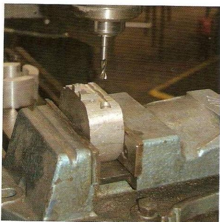
1 Un dispositivo muy sencillo para el fresado de un trozo de metal. La herramienta de corte, que se asemeja a una broca plana, va instalada por encima de la pieza de trabajo, que está embridada.
