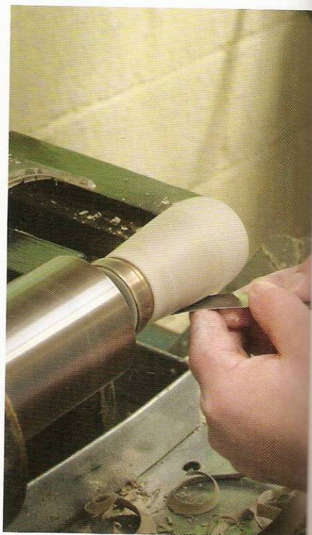
2 Acabado de una mano de mortero de cerámica con una herramienta alisadora plana.
