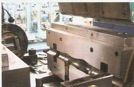
1 Un ejemplo de la maquinaria y de la cavidad del molde en la que se aloja el metal.
