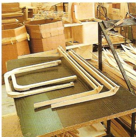
2 Las piezas ya conformadas y listas para el montaje.
