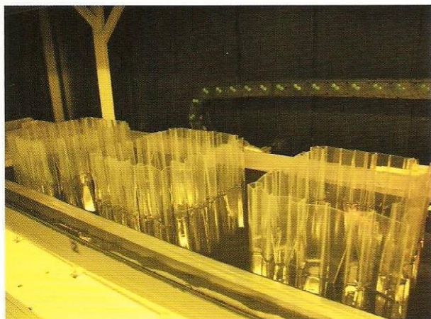
1 Esta imagen de un modelo de silla C1 diseñado por Patrick Jouin nos muestra el producto terminado en el momento en que es extraído del baño polimérico. Durante la fase de fabricación, la única parte que queda visible es el borde superior de la pieza que el láser va conformando.
