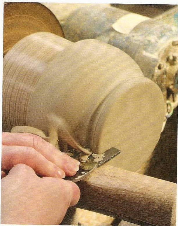
1 El cuenco del mortero se torne a mano utilizando una herramienta convenientemente perfilada para conseguir las formas justas.
