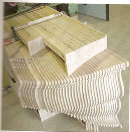
1 Las planchas individuales de madera contrachapada se embridan conjuntamente antes de someterse al tratamiento mecánico.
