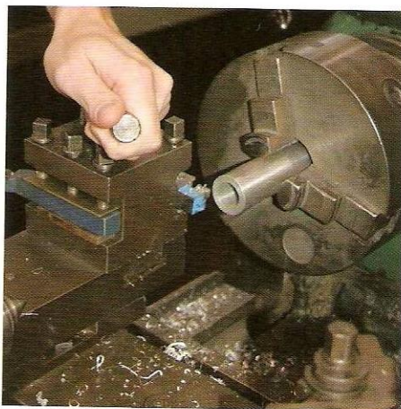
2 Un dispositivo simple para una operación de torno en la que el tubo de metal que va a ser seccionado está sujeto a un plato. La herramienta de corte está lista para realizar su función.
