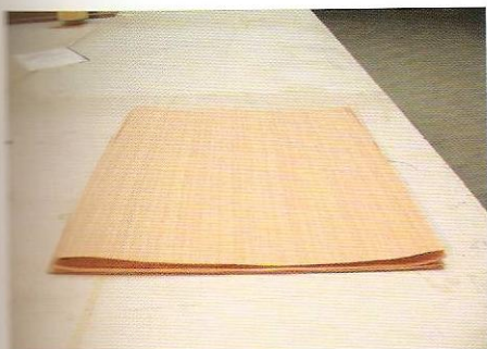
1 El apilado de chapas de madera pretratadas se dispone alternando la dirección de las vetas.
