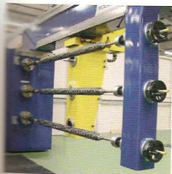
1 En la imagen vemos tres tubos de material compuesto sometidos a un proceso de conformado en una bobinadora de filamentos de tres husos.
