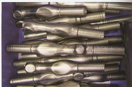
2 Objetos semiacabados producidos mediante hidroconformado.
