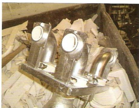
5 Fase en la cual la cerámica seca se retira y se descarta, quedando visible el producto final.
