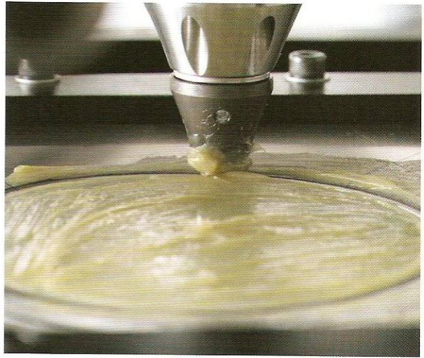
Este primer plano nos muestra la herramienta de una sola punta descendiendo sobre la chapa amordazada y lista para el conformado.
