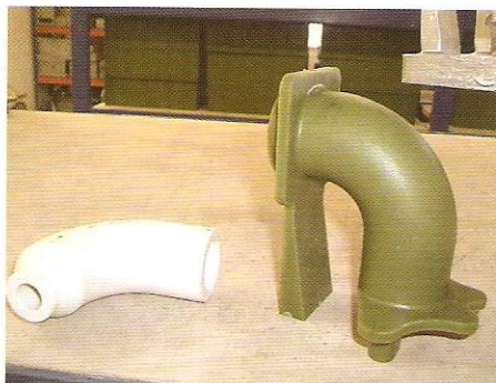
1 Una vez fabricada la matriz, producimos un patrón de cera (a la derecha).
