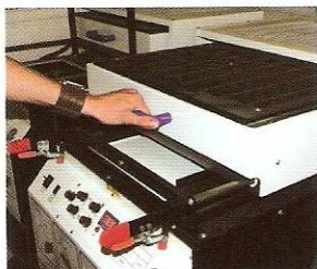
3 Se baja el calentador para colocarlo sobre la lámina plástica.
