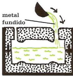
4 Se vierte el metal fundido en los canales, rellenando así la cavidad del molde.
