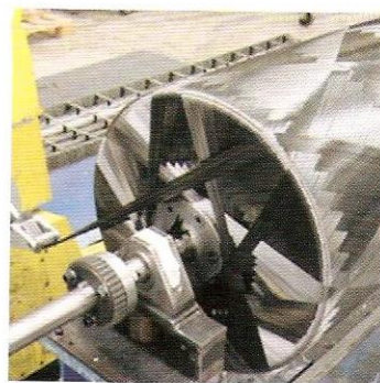
3 Se aprecia con claridad el patrón de devanado helicoidal de las fibras.
