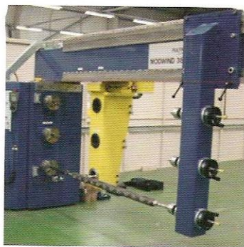
2 El brazo de control, de color amarillo, va cargando las fibras impregnadas de resina sobre el mandril tubular (el baño de resina está fuera de la fotografía).
