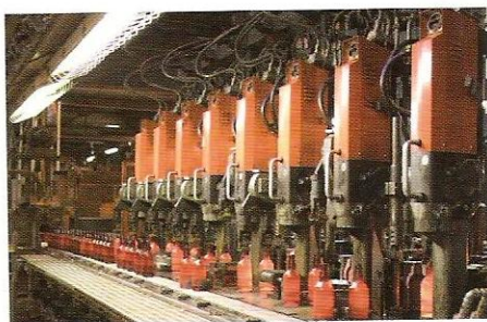
4 Una serie de ocho máquinas moldeadoras van colocando las botellas en la cadena de producción, justo antes del recocido.
