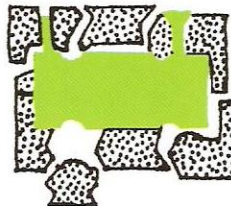
5 Una vez enfriada la colada, se extrae la pieza de la arena.
