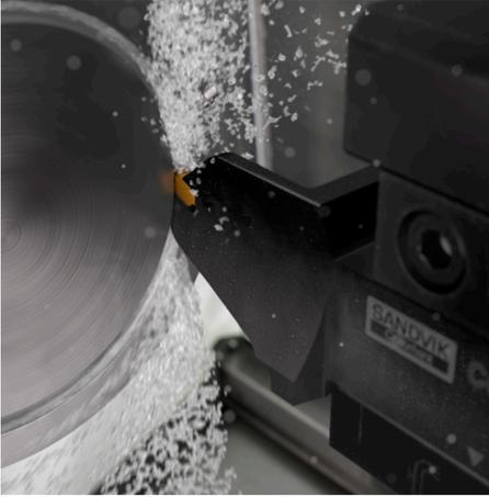
Para realizar ranuras axiales en la parte frontal de las piezas, se necesitan herramientas especiales.
