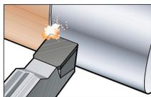
Lo habitual es que exista una relación entre la dureza del material y la vida útil de la herramienta, así como entre los datos de mecanizado y el tipo de geometría y de calidad. A mayor dureza, menor vida útil de la herramienta, con un desgaste más rápido del filo.
