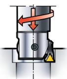
El mandrinado en desbaste de un solo filo se usa cuando el control de la viruta es complicado (material de viruta larga) o cuando la potencia de la máquina-herramienta es limitada. Únicamente se utiliza una corredera. Las superficies de las correderas están protegidas por cubiertas mientras no se usan. Cuando se lleva a cabo un mandrinado de acabado, se usa una herramienta de un solo filo ajustable para las tolerancias de agujero más estrechas, ( $f_n = f_z$ ).
