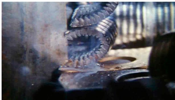
Secuencia de rotura de la viruta típica en una toma de alta velocidad.
