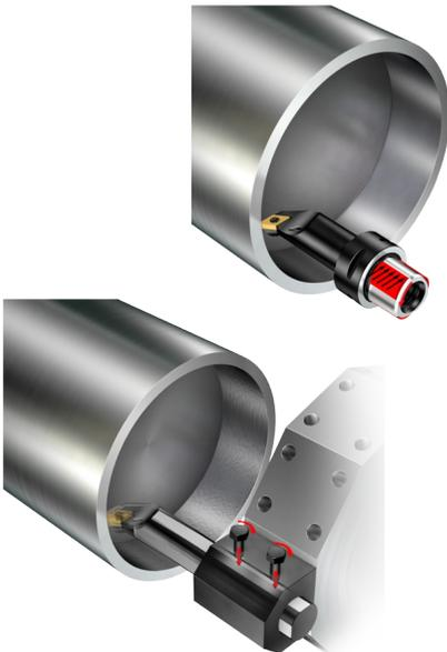
La barra de mandrinar a menudo está sujeta con 2-3 tornillos. Esto provoca problemas de vibración, un acabado superficial deficiente, plaquitas desgastadas demasiado rápido e interrupciones en la producción, con tiempos muertos dedicados al ajuste de los datos de corte y la medición de la pieza.
