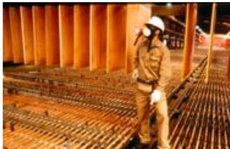
Figura 59. La electrorefinación del cobre se realiza en celdas que son como enormes piscinas.
