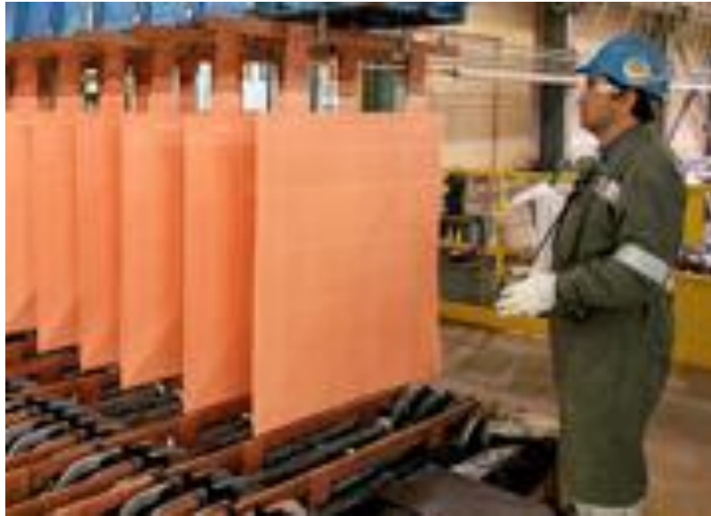
Figura 60. Los cátodos iniciales son láminas de cobre de alta pureza donde se depositará el cobre proveniente del ánodo.
