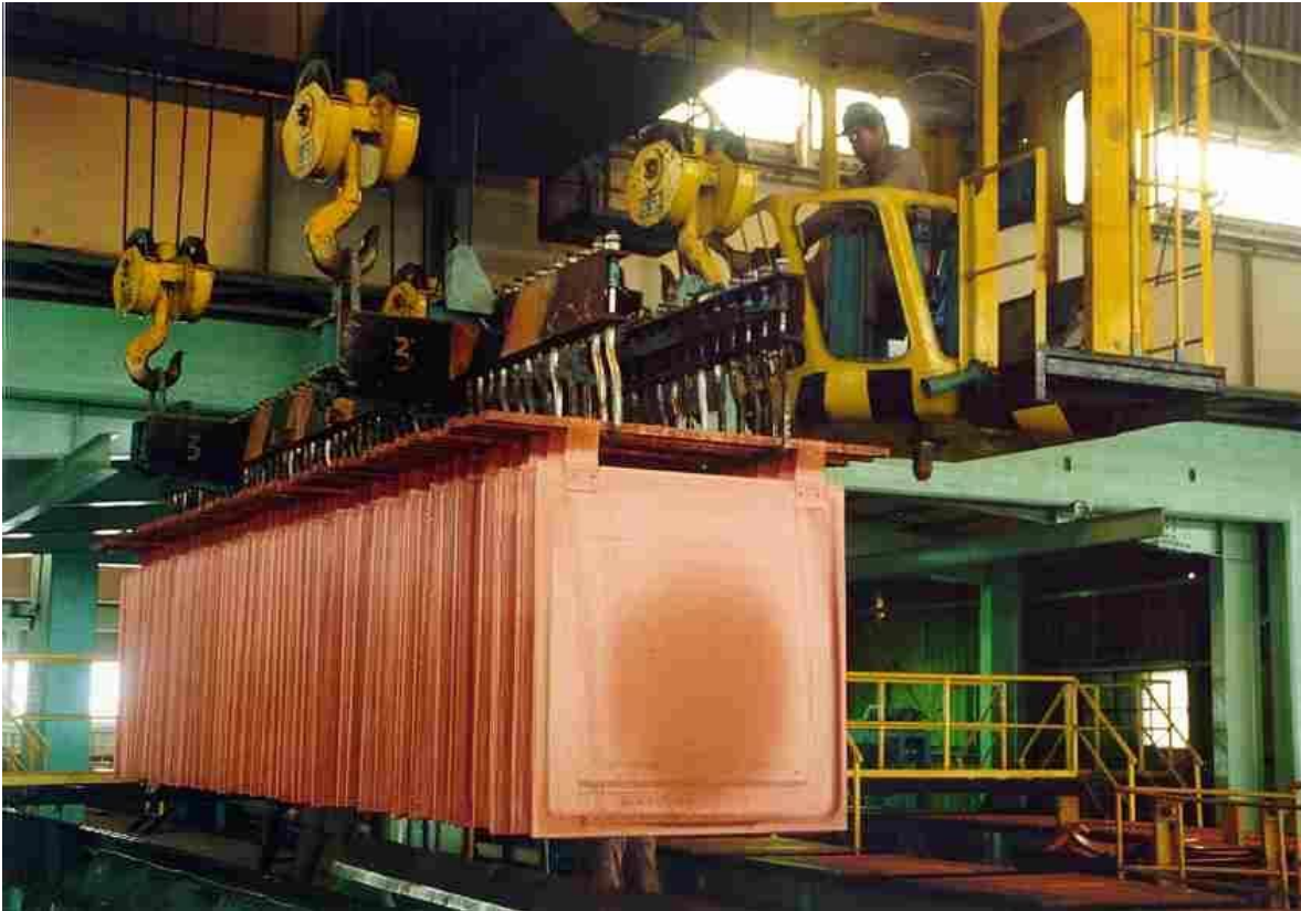
Figura 62. El proceso de electrorefinación dura unos 20 días y en ese plazo se realizan dos “cosechas” de cátodos.
