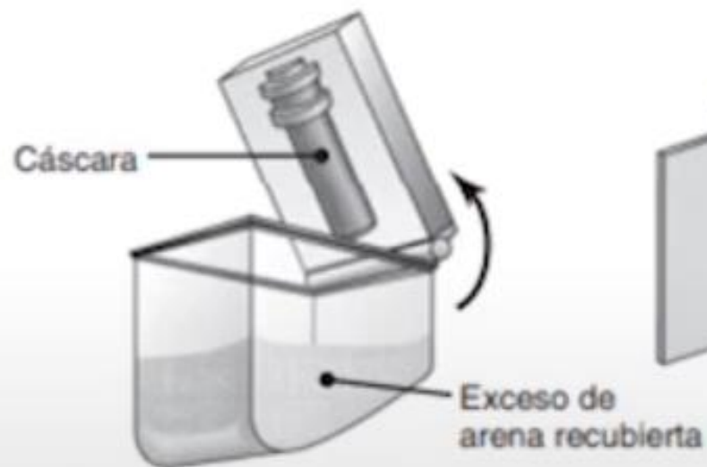
4. Modelo y cáscara retirados de la caja de volteo
