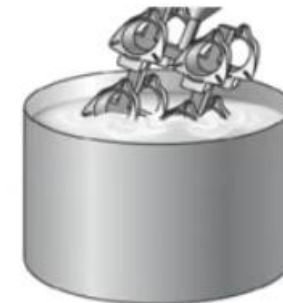
Recubrimiento con suspensión de material refractario
