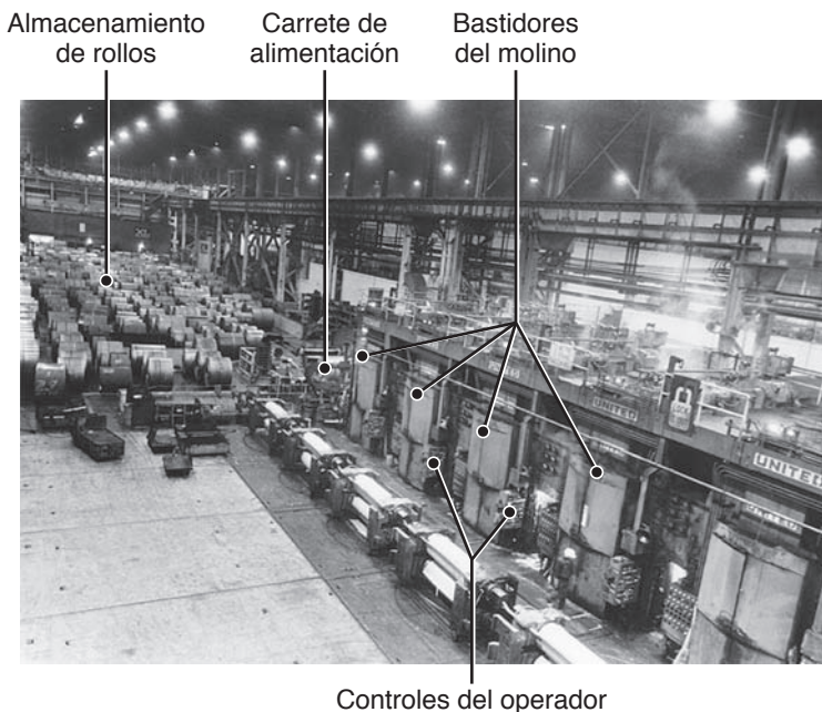
FIGURA 13.10 Vista de un molino de laminación. Fuente: Cortesía de Ispat Inland.
