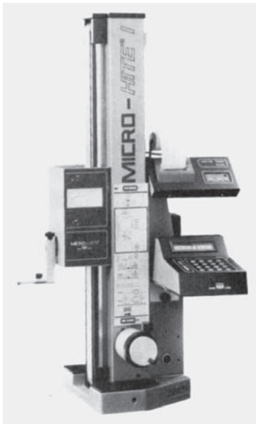
FIGURA 35.14 Instrumento electrónico para medir la longitud vertical, con resolución de 1 \mu\text{m} ( 40 \mu\text{pulg} ). Fuente: Cortesía de TESA SA.
