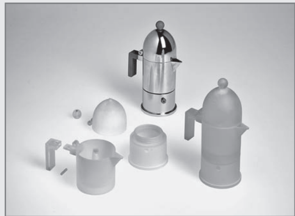
FIGURA 20.7 Prototipos de cafetera producidos mediante el modelado MultiJet y producto final (a la derecha). Fuente: Cortesía de Alessi Corporation y 3D Systems, Inc.
