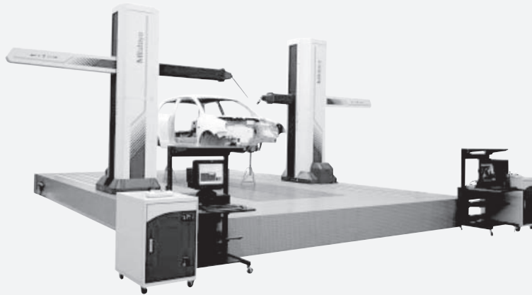
FIGURA 35.17 Máquina grande de medición por coordenadas con dos cabezales que miden varias dimensiones de la carrocería de un automóvil.
