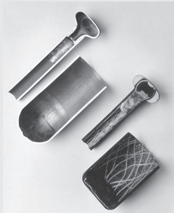
FIGURA I.4 Secciones transversales de bates de béisbol de aluminio (las dos de la parte superior) y de material compuesto (las dos de la parte inferior).
