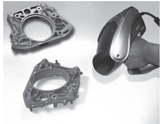
FIGURA 37.27 Uso de un escáner 3D para digitalizar la geometría de un fundido (abajo) para generar un archivo de datos en 3D que describe la geometría (arriba). El archivo de datos se puede usar después para el control de calidad o se puede enviar a una impresora 3D para producir una parte con la misma geometría.
