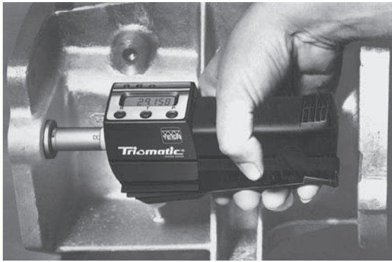
FIGURA 35.13 Calibrador electrónico para medir diámetros internos; el cabezal de medición está equipado con tres pernos de acero con punta de carburo para que tenga resistencia al desgaste. Fuente: Cortesía de TESA SA.
