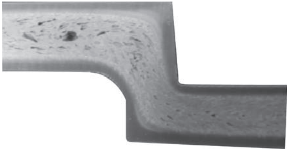
FIGURA 19.20 Sección transversal de un moldeado de espuma estructural que muestra una piel densa y un núcleo poroso. Fuente: Cortesía de M&T Industries.
