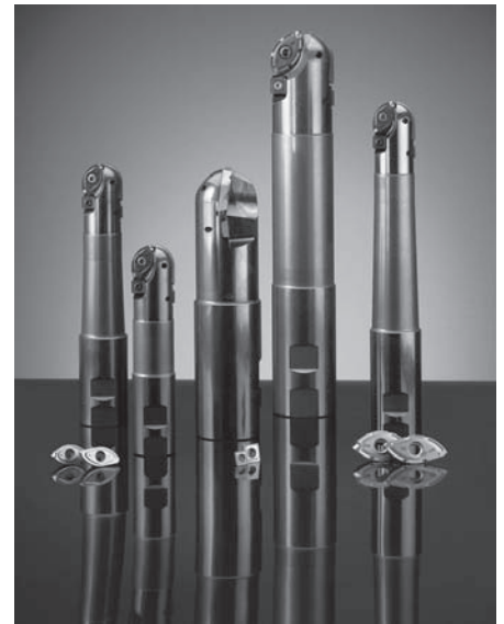
FIGURA 24.13 Fresas con punta de nariz de bola; estos cortadores producen contornos elaborados y es frecuente que se utilicen en el maquinado de dados y moldes (vea también la figura 24.2d). Fuente: Cortesía de Dijet, Inc.
