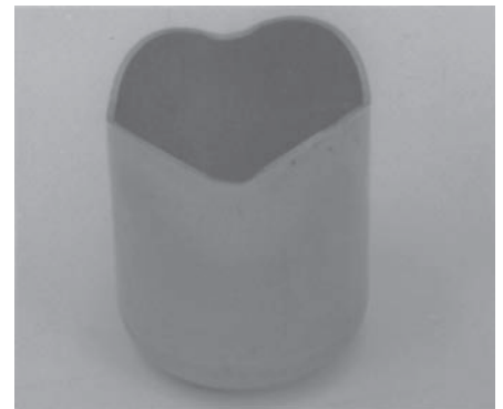
FIGURA 16.35 Bordes ondulados en una copa de acero embutido causados por la anisotropía planar de la lámina metálica.
