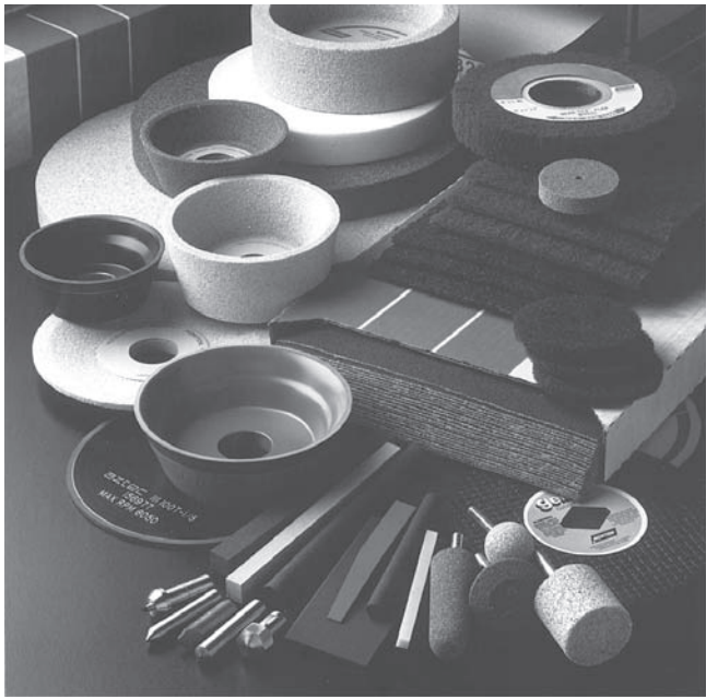
FIGURA 26.2 Varios abrasivos aglutinados que se emplean en los procesos de maquinado por abrasión. Fuente: Cortesía de Norton Company.
