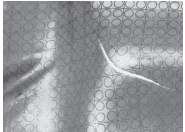
FIGURA 16.15 Deformación del patrón de rejilla y rasgamiento de la lámina de metal durante el formado; los ejes mayor y menor de los círculos se utilizan para determinar las coordenadas en el diagrama de límite de formado que se muestra en la figura 16.14b. Fuente: Según S. P. Keeler.
