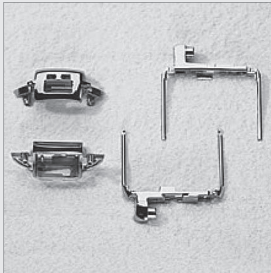
FIGURA 17.19 Componentes de metal en polvo para teléfonos móviles y que les permiten ser plegables.
