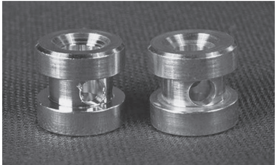
FIGURA 26.35 Ejemplo de eliminación de rebabas con energía térmica. Fuente: Cortesía de Kennametal Extrude Hone Corporation.
