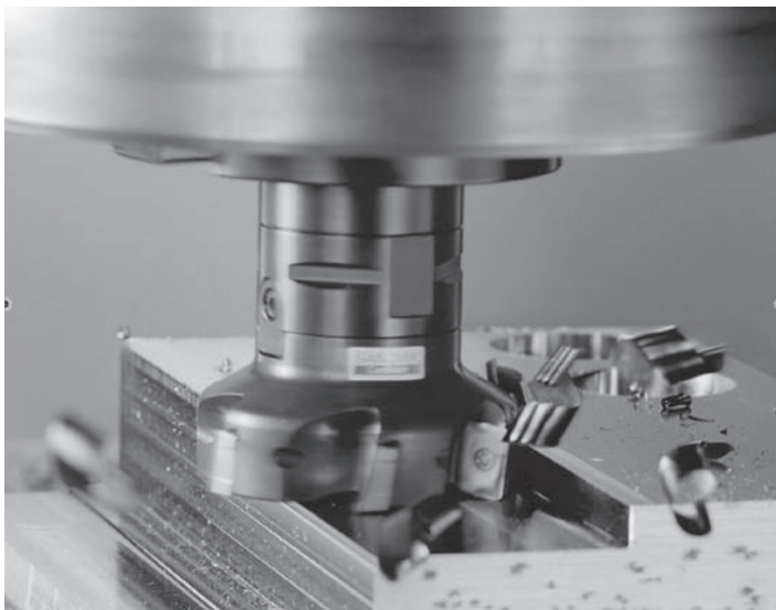
FIGURA 24.3 Acción de corte de una fresadora que usa varios insertos para remover metal. Fuente: Cortesía de Sandvik Coromant.
