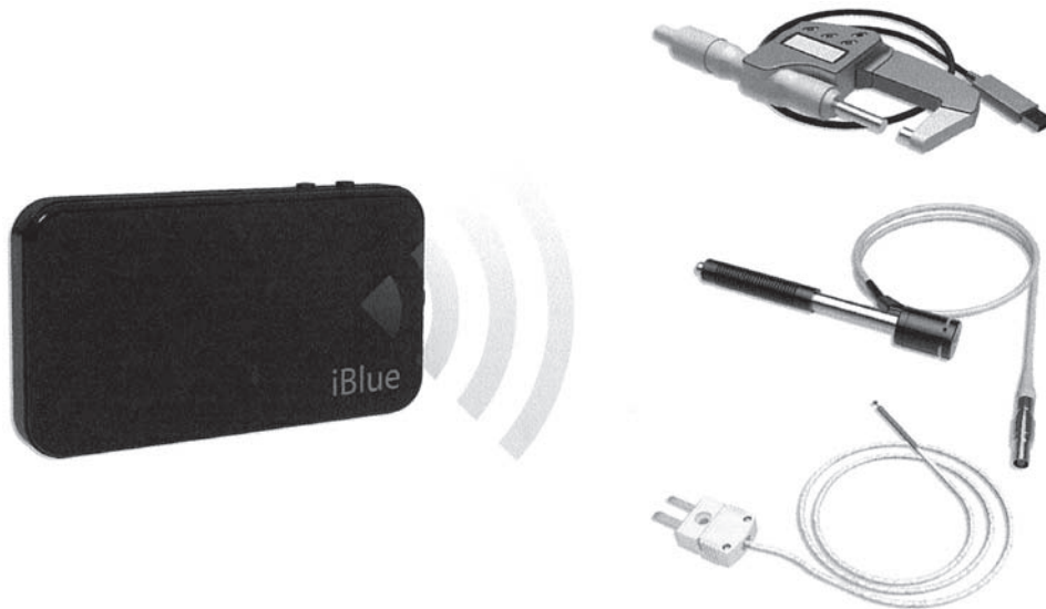
FIGURA 39.4 Equipo de comunicaciones iBlue con un micrómetro (arriba), una sonda de dureza (en medio) y una sonda térmica (abajo). El iBlue es del mismo tamaño que un teléfono móvil y usa el estándar MTConnect para comunicarse con instrumentos y maquinaria. Fuente: Cortesía de J. Neidig, ITAMCI, Inc.
