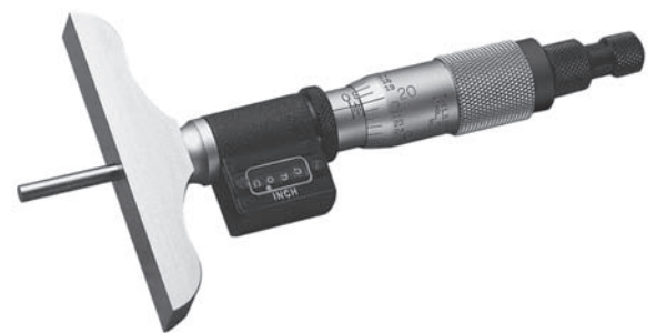
FIGURA 35.3 Micrómetro de profundidad, con escalas digital y de vernier. Fuente: Cortesía de L. S. Starrett Co.
