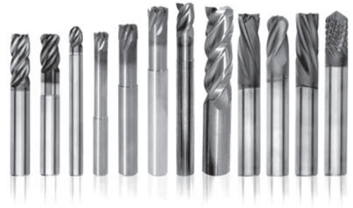
FIGURA 24.12 Selección de fresas frontales; el número de dientes y el ángulo de la hélice se seleccionan con base en si se hará un corte de desbaste o de acabado. Fuente: Cortesía de Kennametal Inc.
