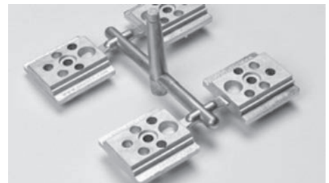
FIGURA 17.18 Muestra de cuatro componentes moldeados por inyección de metal con bebedero, canales y ataques (vea también la figura 19.10). Fuente: Cortesía de HARBEC, Inc.
