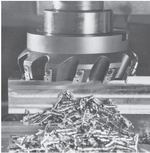
FIGURA 24.7 Fresa de refrentado con insertos indexables. Fuente: Cortesía de Ingersoll Cutting Tool Company.
