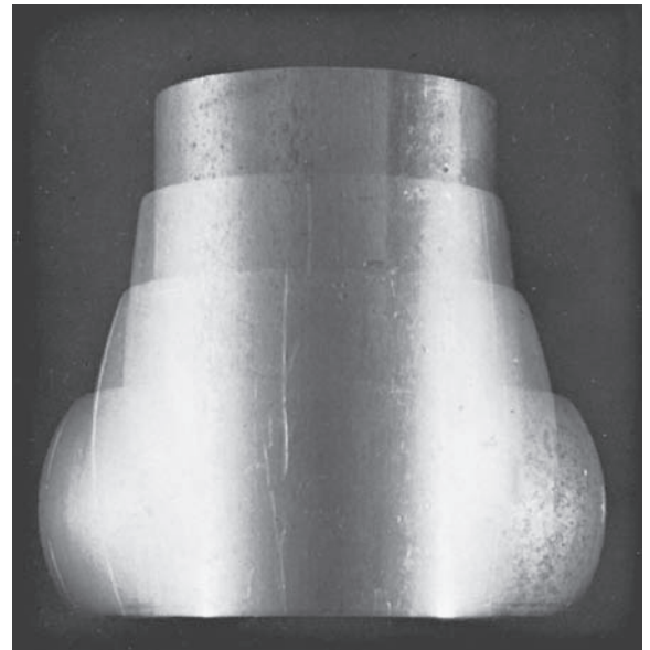
FIGURA 2.8 Abarrilamiento debido a la compresión de una muestra cilíndrica sólida redonda (aluminio 7075-O) entre troqueles planos. El abarrilamiento se debe a la fricción que hay en las interfaces entre los dados y la muestra, lo que retarda el flujo libre del material (vea también la figura 14.3).
