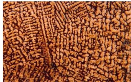
Figura 7. La fotografía de la estructura dendrítica para aleación 70/30 (izquierda), 60/40 (derecha), a un aumento de 18x.
