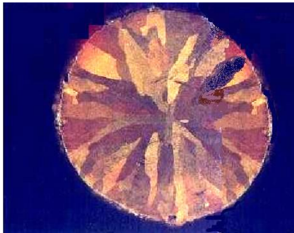
Figura 6. Fotografía de los granos de las piezas de latón a un aumento de 4x (Diámetro original de la pieza 2 cm).
