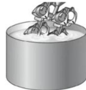
Recubrimiento con suspensión de material refractario
