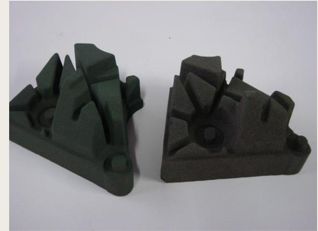
Los moldes de **arena verde** están elaborados con una mezcla de arena, arcilla y agua; la palabra verde se refiere al hecho de que el molde contiene humedad en el momento del vertido. Los moldes de arena verde tienen resistencia suficiente para la mayoría de aplicaciones, buenas colapsabilidad, permeabilidad y posibilidades de reuso, y son los menos caros de todos los moldes
