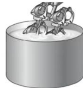
Recubrimiento con suspensión de material refractario
