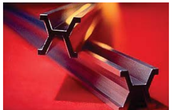
Patrones de medida del metro, utilizados de 1889 a 1960, compuestos de una aleación de platino e iridio.
