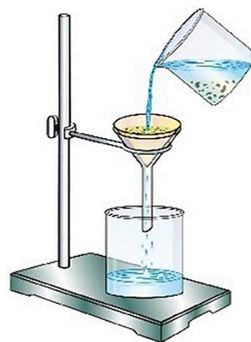
Figura 3. Sistema de filtración
