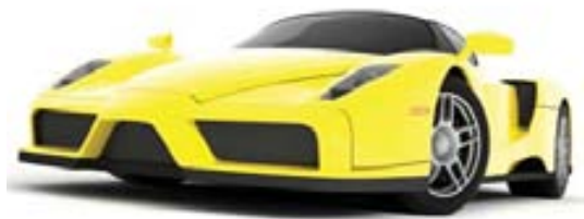
El Ferrari Enzo tiene una carrocería con materiales compuestos de fibra de carbono.
