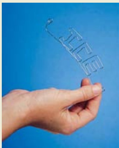
Se forma la palabra ICE a partir del alambre de Nitinol.
