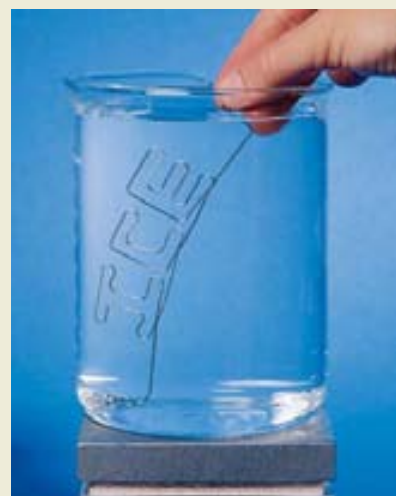
El alambre regresa a ICE cuando se sumerge en agua caliente.
