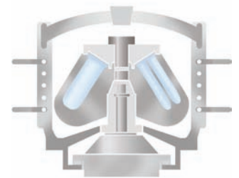
Figura 1.17 Centrifugación con centrifuga eléctrica La fuerza centrífuga acelera la sedimentación de los componentes sólidos de una mezcla.
