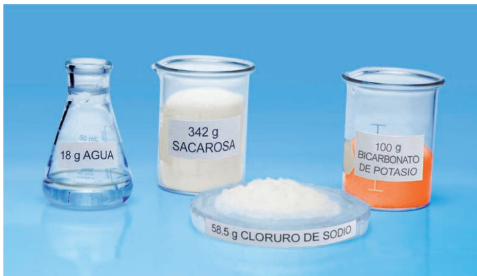
Figura 7.8 Masa molar de algunos compuestos. Cada muestra contiene 6.02 \times 10^{23} moléculas de un compuesto covalente o 6.02 \times 10^{23} unidades fórmula de un compuesto iónico. Cada compuesto tiene su propia masa molar.
