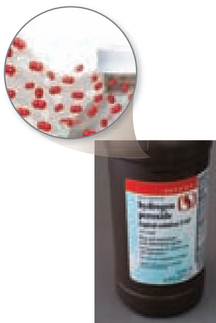
▲ FIGURA 7.25 Disolución de peróxido de hidrógeno en botellas con tapas ventiladas.
