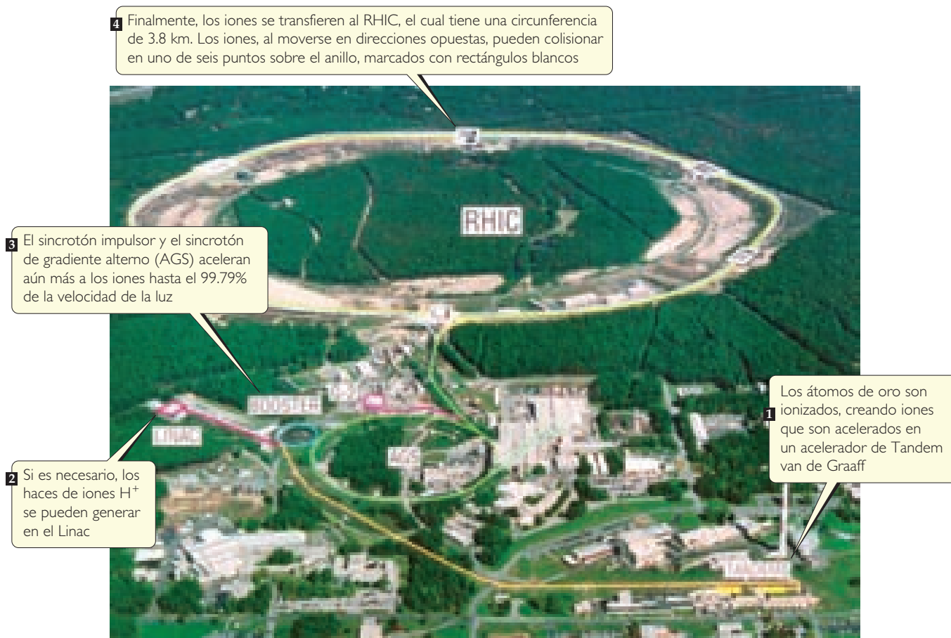
▲ FIGURA 21.5 Colisionador de iones pesados relativistas. Este acelerador de partículas está localizado en el Laboratorio Nacional Brookhaven, Long Island, Nueva York.
