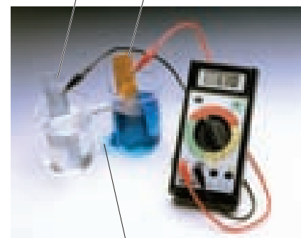
▲ FIGURA 20.4 Una celda voltaica de Cu-Zn basada en la reacción de la ecuación 20.7.
