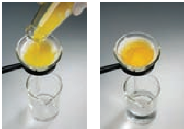
▲ FIGURA 1.12 Separación por filtración. La mezcla de un sólido y un líquido se vierte a través de papel filtro. El líquido pasa a través del papel, mientras que el sólido se queda en el papel.
