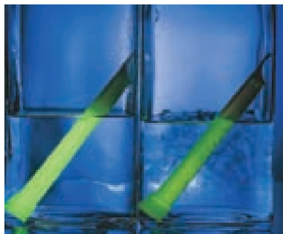
► FIGURA 14.13 La temperatura afecta la velocidad de reacción de quimiluminiscencia de las barras luminosas.
