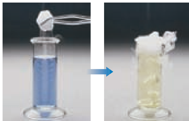
▲ FIGURA 7.17 Reacción de \text{CO}_2 con agua que contiene un indicador azul de bromotimol. Inicialmente, el color azul nos indica que el agua es ligeramente básica. Cuando se agrega un trozo de dióxido de carbono sólido (“hielo seco”), el color cambia a amarillo, lo que indica que se trata de una disolución ácida. El humo se debe a las gotas de agua en el aire que se condensan por medio del frío gas \text{CO}_2 .
