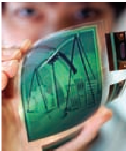
▲ FIGURA 11.35 Papel electrónico (e-paper), producto de la tecnología de cristal líquido colestérico.
