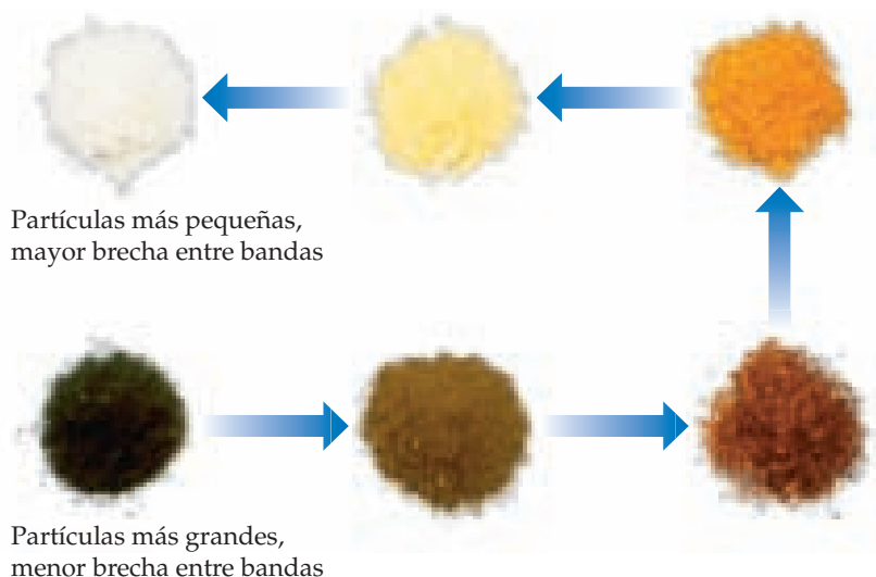
◀ FIGURA 12.43 Polvos de \text{Cd}_3\text{P}_2 con diferentes tamaños de partícula. Las flechas indican la disminución de tamaño de la partícula y un aumento correspondiente en la energía de la brecha entre bandas.
