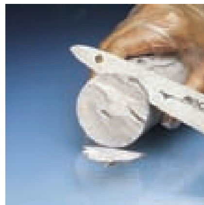
▲ FIGURA 7.19 El sodio, como los otros metales alcalinos, es bastante suave como para poderse cortar con un cuchillo.
