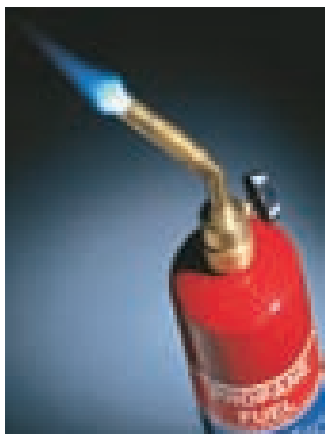
▲ FIGURA 3.8 El propano arde en aire. El propano líquido en el tanque, C_3H_8 , se evapora y se mezcla con el aire conforme escapa por la boquilla. La reacción de combustión de C_3H_8 y O_2 produce una flama azul.
