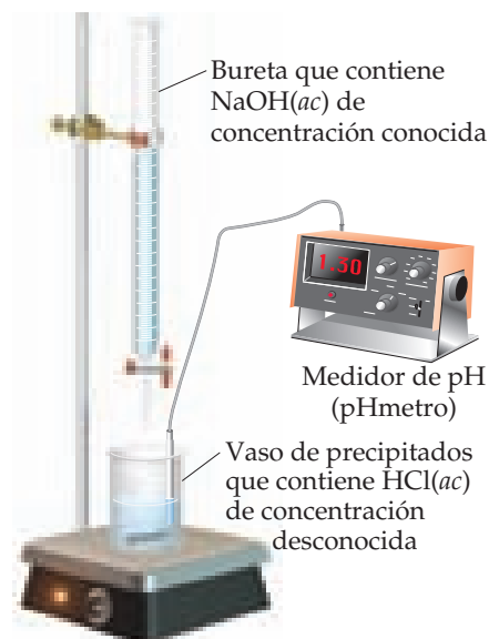
▲ FIGURA 17.6 Medición del pH durante una titulación.
