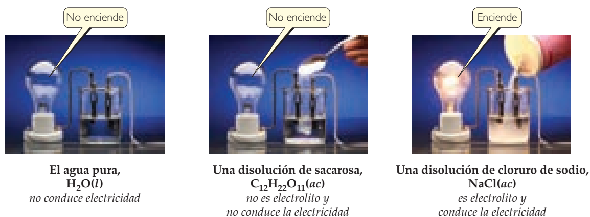
◀ FIGURA 4.2 Conductividades eléctricas del agua y de dos disoluciones acuosas.
