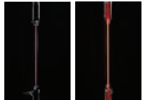
▲ FIGURA 6.10 Emisión atómica de hidrógeno y neón. Diferentes gases emiten luz de distintos colores característicos cuando una corriente eléctrica pasa a través de ellos.
