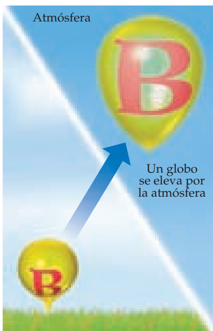
▲ FIGURA 10.5 Conforme un balón se eleva en la atmósfera, aumenta su volumen.
