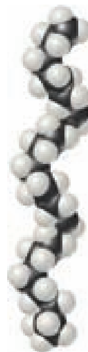
► FIGURA 12.39 Un segmento de una cadena de polietileno. Este segmento consta de 28 átomos de carbono. En el caso de los polietilenos comerciales, las longitudes de la cadena varían de 10^3 a 10^5 unidades de \text{CH}_2 .
