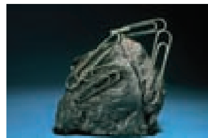
▲ FIGURA 23.6 Imán permanente. Los imanes permanentes están hechos de materiales ferromagnéticos y ferrimagnéticos.
