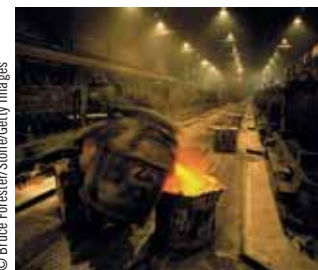
B Colada de aluminio fundido. Las celdas electrolíticas que se emplean en el proceso Hall-Héroult aparecen de fondo.
