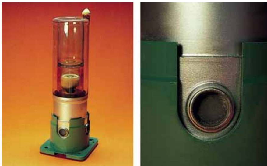
Tubo de rayos X de laboratorio ( izquierda ) y vista de cerca de una de sus ventanas ( derecha ). Las ventanas están hechas de berilio metálico.
