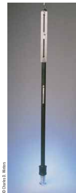
A Barómetro comercial de mercurio.
