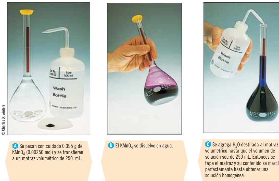
Figura 3.2 Preparación de una solución de \text{KMnO}_4 0.0100 M, permanganato de potasio. Una muestra de 250 mL de solución de \text{KMnO}_4 0.0100 M contiene 0.395 g de \text{KMnO}_4 (1 mol = 158 g).
