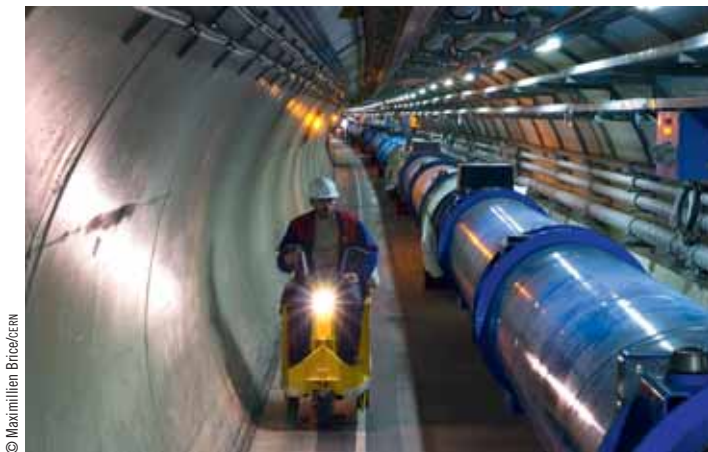
El Gran Colisionador de Hadrones (LHC, por su sigla en inglés) del Laboratorio Europeo de Física de Partículas (CERN), a lo largo de la frontera entre Suiza y Francia, tiene más de 26 kilómetros de circunferencia. Recientemente, el LHC proporcionó evidencia acerca de la por largo tiempo buscada partícula subatómica conocida como bosón de Higgs.
