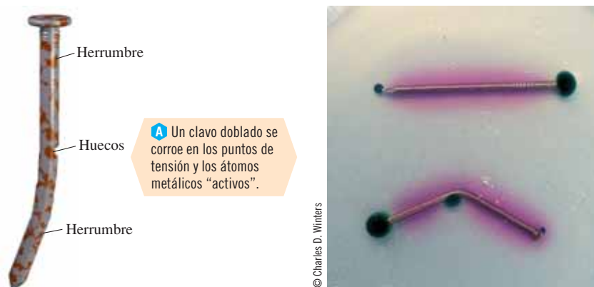
Figura 21.11 Corrosión común del acero (hierro).
