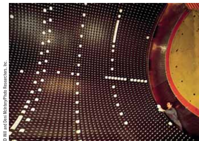
Un técnico limpia los bloques de vidrio de plomo que forman parte del detector de partículas gigante OPAL del CERN, el Laboratorio Europeo de Física de Partículas, cerca de Ginebra, Suiza.
