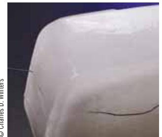
Un alambre lastrado corta un bloque de hielo, el cual se funde por la alta presión del alambre y se vuelve a congelar luego del paso del alambre.
