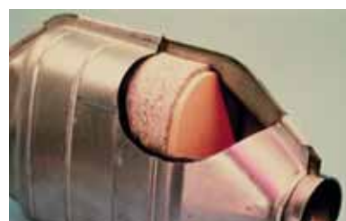
B Vista en corte de un convertidor catalítico, donde se muestran las pastillas del catalizador.
