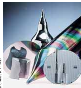
Varias muestras de silicio elemental. El círculo de la parte inferior derecha es un disco de silicio ultrapuro en el cual se han grabado muchos circuitos electrónicos.
