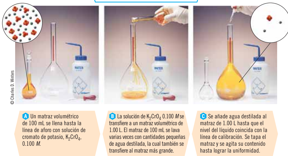
Figura 3.3 Dilución de una solución. La concentración de la nueva solución es \text{K}_2\text{CrO}_4 0.0100 M (100 mL de solución de \text{K}_2\text{CrO}_4 0.100 M se diluyeron a 1000 mL). Tanto los 100 mL de la solución original como los 1000 mL de la solución final tienen la cantidad de \text{K}_2\text{CrO}_4 disuelta en los 100 mL originales de \text{K}_2\text{CrO}_4 0.100 M.
