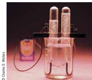
Electrólisis del agua
