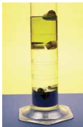
Seis materiales con densidades diferentes. Las capas líquidas son gasolina (arriba), agua (en medio), y mercurio (abajo). Un corcho flota en gasolina. Un pedazo de madera se hunde en la gasolina, pero flota en agua. El cobre se hunde en el agua, pero flota en mercurio.
