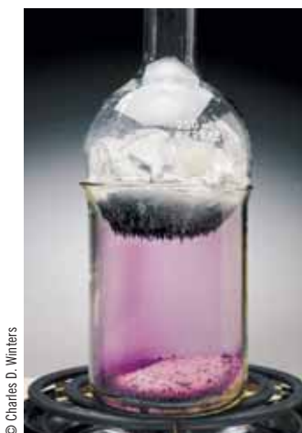
Figura 13.16 La sublimación puede usarse para purificar sólidos volátiles. El yodo, \text{I}_2 , sublima con facilidad; el vapor de \text{I}_2 es de color violeta. La presión de vapor elevada del \text{I}_2 sólido en la mezcla de abajo permite que sublime cuando se calienta. Se forman cristales de yodo puro cuando el vapor se deposita sobre una superficie más fría del aparato (arriba), donde se solidifica.
