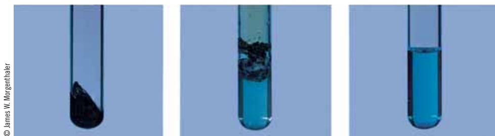
El sulfuro de cobre(II), \text{CuS} , es negro. Conforme el \text{CuS} se disuelve en \text{HNO}_3 6 M, parte del \text{NO} se oxida al gas café \text{NO}_2 con el \text{O}_2 del aire. Esto da como resultado una solución de iones \text{Cu}^{2+} ( \text{SO}_4^{2-} y los contraaniones \text{NO}_3^- ) que es azul.
