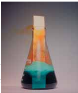
Ácido nítrico, \text{HNO}_3 , p. f. = -42^\circ\text{C} , p. e. = 83^\circ\text{C} ; longitudes de enlace N—O (terminal) 1.22 Å, N—OH 1.41 Å.
