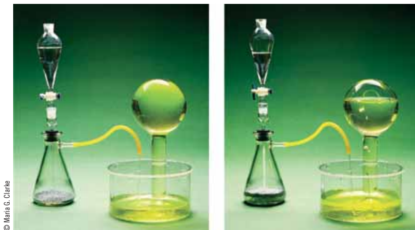
Figura 12.7 Aparato para preparar hidrógeno a partir de zinc y ácido sulfúrico.
