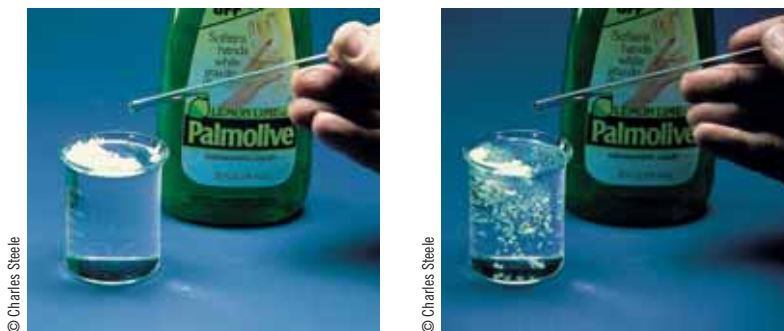
(Izquierda) El azufre en polvo flota en agua pura debido a la elevada tensión superficial de ésta. (Derecha) Cuando se agrega al agua una gota de solución de detergente, su tensión superficial se reduce y el azufre se hunde. Este abatimiento de la tensión superficial intensifica la acción limpiadora de las soluciones detergentes.
