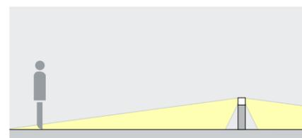
La baliza Panorama es ideal para la iluminación de grandes superficies. Con un diámetro del cono luminoso de hasta 12m y una iluminancia exterior de 0,5lx, es una potente herramienta para la iluminación de
