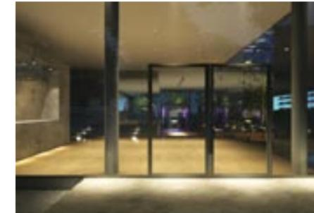
1 Entrada: Escenificación de un «alfombra de bienvenida» de luz para el exterior y el interior. Los Downlights proporcionan una iluminación básica homogénea en el vestíbulo. El mostrador de recepción y la guardarropa se tratan por separado en función de las tareas visuales.
