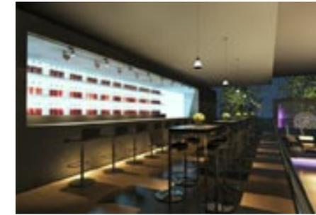
2 Bar: El juego cromático dinámico de la pared posterior retroiluminada puede manejarse independientemente de la luz ambiental. Los proyectores sirven para la iluminación antideslumbrante de la estantería para botellas y de la barra. Las luminarias pendulares rebajan la altura del punto de luz sobre las mesas de pie.
