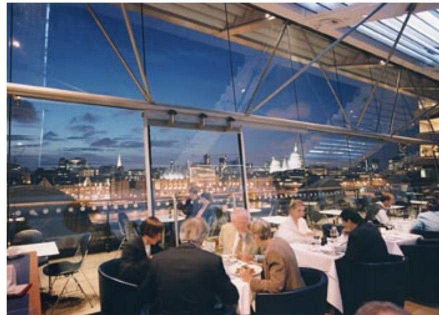
La vista del interior al exterior requiere unas luminarias perfectamente apantalladas y una disposición adecuada de las luminarias, a fin de evitar reflejos de las luminarias en la fachada de vidrio. Para gozar de una buena vista del cielo nocturno, el interior debería presentar las mínimas iluminancias posibles, para que se refleje en la fachada el menor número de elementos posible.
