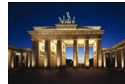
Los bañadores de pared con lente se asignaron a las columnas para acentuarlas. Los bañadores en los techos de los pasos de la puerta iluminan las paredes.
