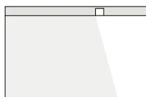
Bañador de pared para lámpara reflectora con una lente para la dispersión del cono luminoso y un reflector de apantallamiento. La parte de iluminación en el suelo es baja, la iluminación de la pared es especialmente uniforme.
