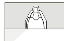
Bañador de pared integrado en techo para lámparas reflectoras PAR 38.
