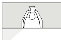
Constituyen el soporte de la iluminación tres canales de instalación dispuestos en paralelo a las ventanas. En ellos se instalan dos luminarias de retícula para iluminar el puesto de trabajo, Downlights para la mesa de trabajo y de reuniones, y proyectores orientables para la iluminación de la pared de armarios. Salidas de conexión pueden adicionalmente servir para el montaje de proyectores para la iluminación de superficies de pared libres.
