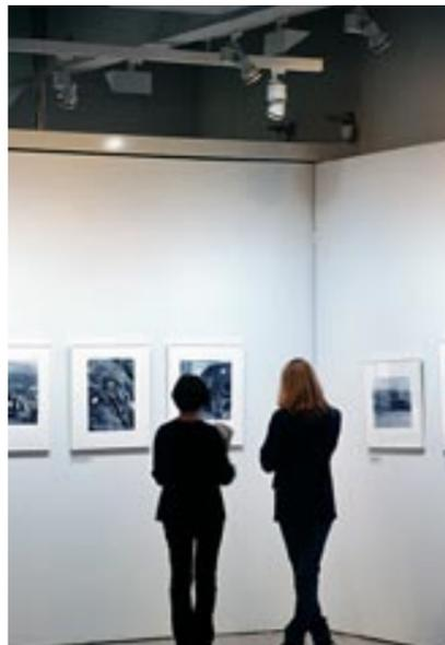
A través de la combinación de bañadores de pared y proyectores, la iluminación general puede ser complementada mediante una iluminación acentuadora.
