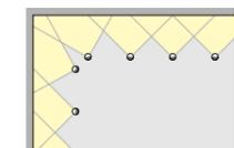
Las franjas laterales de la disposición que se aprecia más arriba, se pueden suprimir mediante una disposición doble de los bañadores de pared en la esquina.
