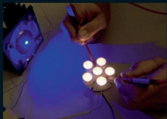
Cada una de las luminarias con compensación cromática es sometida en fábrica a una medición y un calibrado individuales. Los factores de compensación se guardan de manera permanente en el equipo auxiliar.
