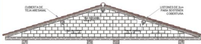
Detalle cubiertas. Fuente: Elaboración del investigador
