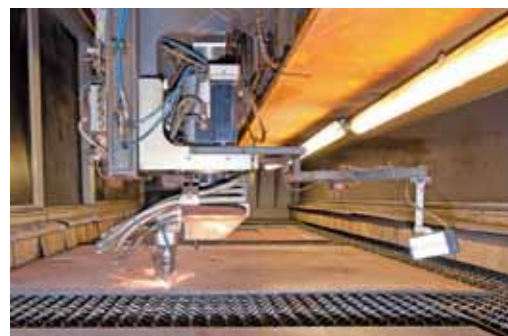
Figura 41.31 Estas tijeras láser robóticas, que pueden cortar hasta 50 lienzos de tela en una sola pasada, es una de las muchas aplicaciones de la tecnología láser.
