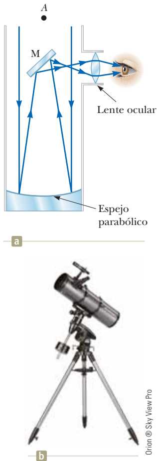
Figura 35.45 (a) Telescopio de reflexión de enfoque newtoniano. (b) Telescopio de reflexión. Este tipo de telescopio es más corto que el de la figura 35.44b.
