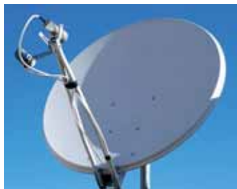
Figura 35.10 Una antena parabólica para satélite es un reflector cóncavo para señales de televisión de un satélite en órbita alrededor de la Tierra. Puesto que el satélite está tan alejado, las señales son transportadas por microondas que resultan paralelas cuando llegan a la antena parabólica. Estas ondas se reflejan del plato y se enfocan en el receptor.
