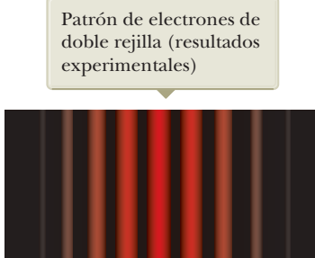
Figura 39.22 (a)-(c). Patrones de interferencia simulados por computadora de un haz de electrones que inciden sobre una doble rejilla. (d) Fotografía de un patrón de interferencia de doble rejilla producido por electrones.
