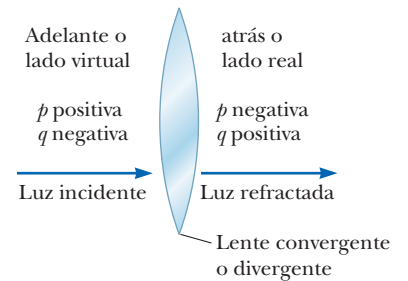
Figura 35.25 Diagrama para obtener los signos de p y de q para lentes delgadas. (Este diagrama también es aplicable a una superficie refractora.)
