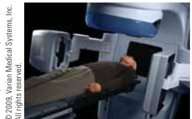
Figura 41.23 El bremstrahlung es generado por esta máquina y usado para tratar el cáncer en un paciente.
