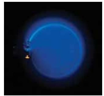
Figura 28.10 (Ejemplo 28.3) Flexión de un haz de electrones en un campo magnético.
