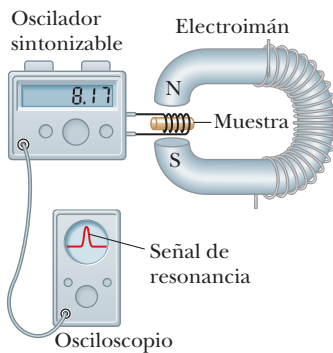
Figura 43.30 Aparato experimental para la resonancia magnética nuclear. El campo magnético de radiofrecuencia, producido por la bobina que rodea a la muestra y suministrado por el oscilador de frecuencia variable, está orientado en forma perpendicular respecto al campo magnético constante producido por el electroimán. Cuando los núcleos en la muestra cumplen con la condición de resonancia, absorben energía proveniente del campo de radiofrecuencia de la bobina, y esta absorción modifica las características del circuito del cual forma parte esta última. La mayoría de los espectrómetros RMN modernos se valen de imanes superconductores con intensos campos fijos que funcionan a frecuencias de alrededor de 200 MHz.
