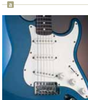
Figura 30.5 (a) En una guitarra eléctrica una cuerda magnetizada en vibración induce una fem en una bobina captadora. (b) Las bobinas captadoras (los círculos que aparecen por debajo de las cuerdas metálicas) de esta guitarra eléctrica, detectan las vibraciones de las cuerdas y envían esta información a través de un amplificador a los altavoces. (Un interruptor en la guitarra permite al ejecutante seleccionar el conjunto de las seis bobinas captadoras que se van a utilizar.)
