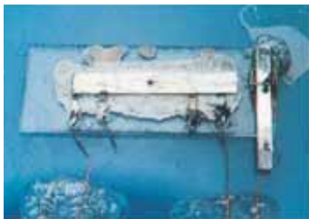
Figura 42.30 Primer circuito integrado de Jack Kilby, probado el 12 de septiembre de 1958.
