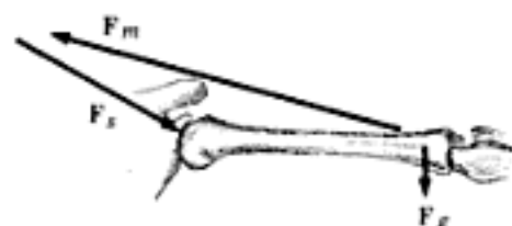
FIGURA 2.37 Las fuerzas que actúan sobre un brazo estirado.
