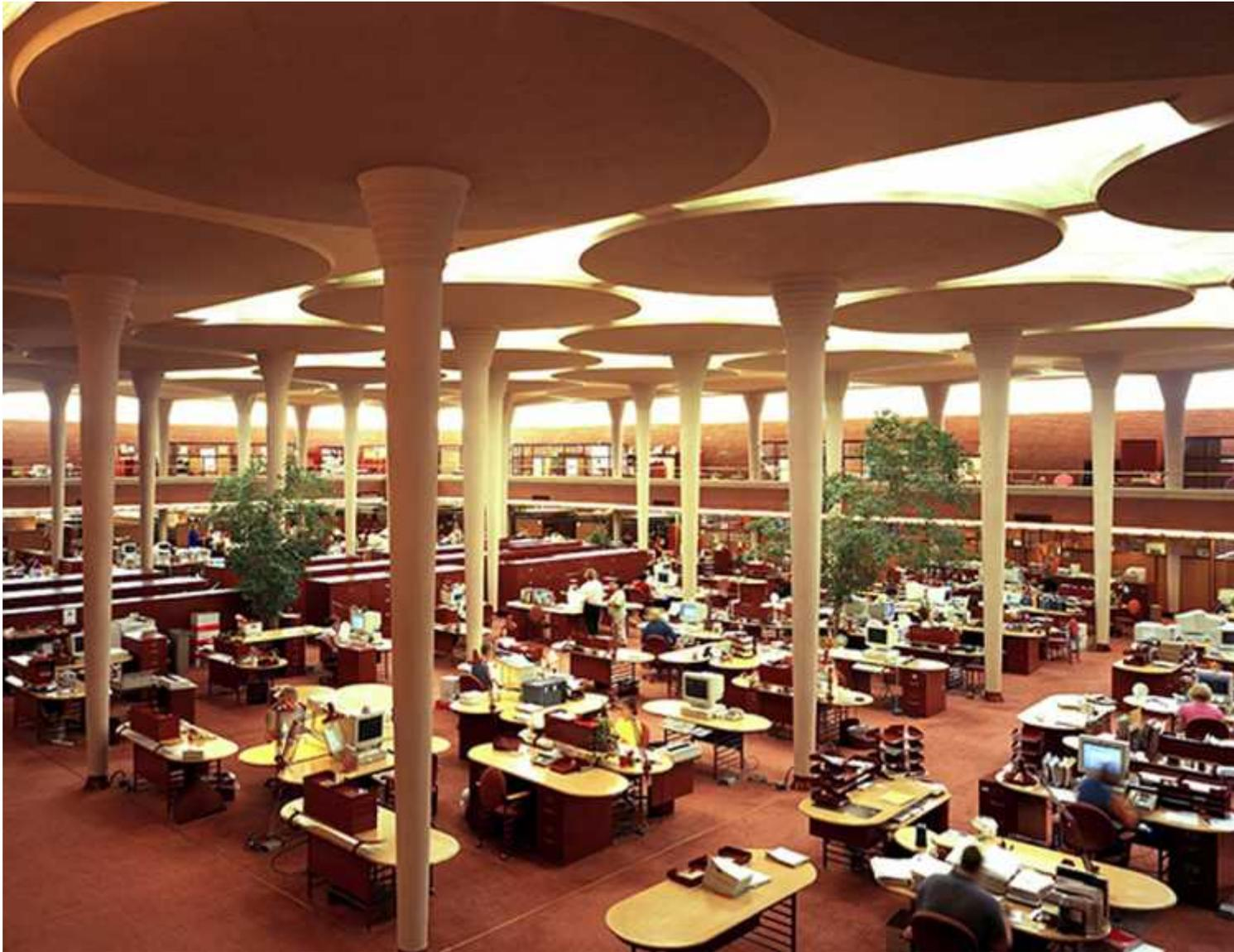
La construcción del edificio de la Johnson Wax creó controversias al arquitecto. En la Gran Sala de Trabajo, las columnas dendriformes tienen un [diámetro](#) de 23 cm en la base y 550 cm en la parte superior, en una plataforma circular que Wright denominó el "nenúfar." Esta diferencia en diámetro entre la base y la parte superior no cumplía con las normas de construcción de la época.
