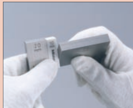
Ejemplo de aplicación Perfecta adherencia entre bloques patrón de acero y cerámicos.
