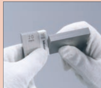
Ejemplo de aplicación Unión de bloques cerámicos y de acero
