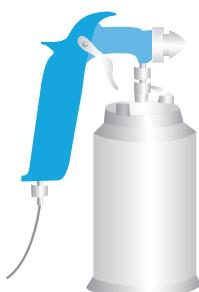
Cuando se va a aplicar pintura con compresor y soplete se debe purgar el tanque del compresor, para eliminar agua y aceite que generalmente se encuentran en el recipiente.
