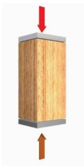
Esquema de ensayo de compresión paralela a las fibras.
