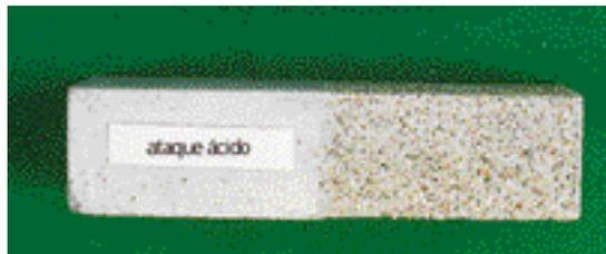
FIG. 3.7.1 Prisma de mezcla del cual la mitad izquierda ha sido sometida a la agresión ácida.
