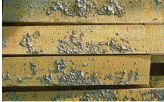
FIG. 2.6.3 Fragmentos de superficie de hormigón adheridos al encofrado.
