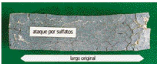
FIG. 3.6.1 Aumento del volumen de un prisma de mezcla inmerso en una solución con alto tenor de sulfatos (mezcla confeccionada con cemento normal).
