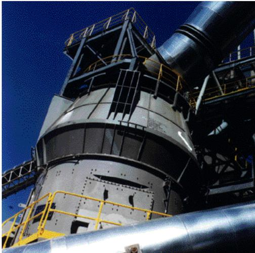
FIG. 1.1.2 Molino vertical para la reducción a harina de la mezcla de materias primas.
