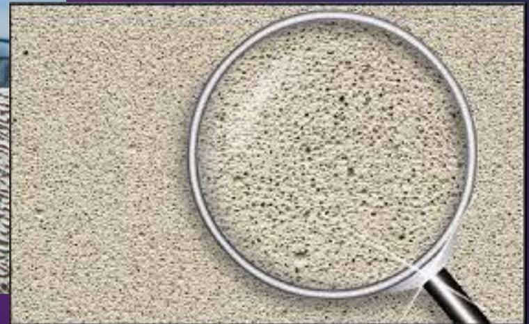
Hormigón celular curado en autoclave
