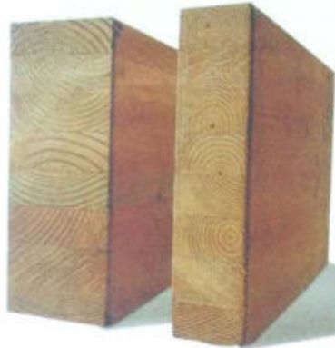
Fig. 23. Secciones de madera laminada: una reforzada con fibras sintéticas (derecha) y la otra no.
