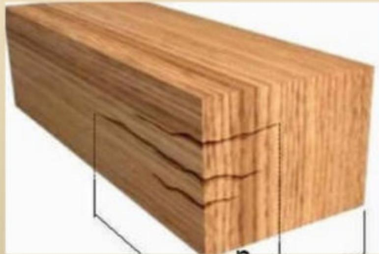
**Acebolladuras**: son roturas locales de la madera, producidas entre los anillos de crecimiento y a lo largo del eje del árbol, causadas, por esfuerzos que inciden sobre la madera
