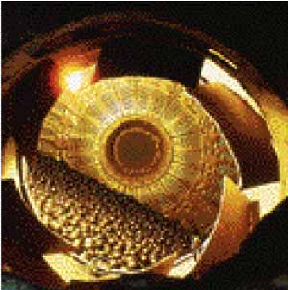
*Vista interna de un molino de bolas para el molido del clinker y el yeso en cemento.*
