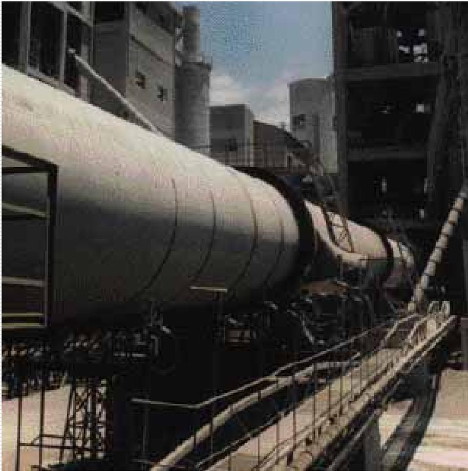
*Horno rotativo, corazón del proceso productivo del cemento.*
