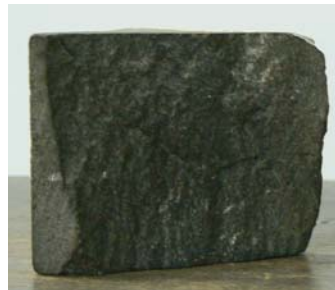
Probeta cúbica ya ensayada
