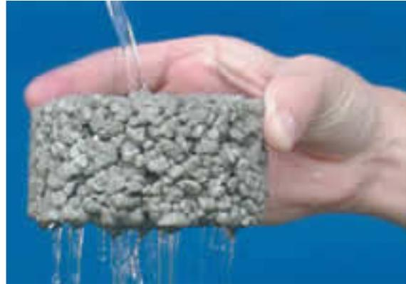
$$\text{Absorción \%} = \frac{\text{Peso saturado} - \text{Peso seco}}{\text{Peso seco}} \cdot 100$$
