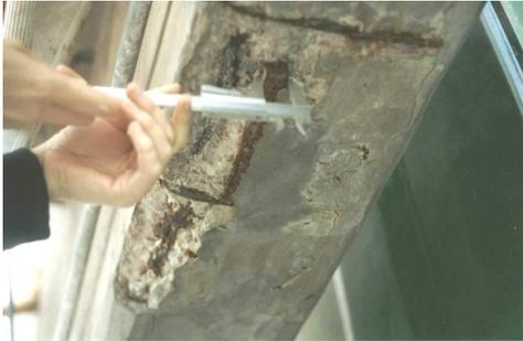
Ensayo de destructivo: detección de la posición de armaduras de acero por roturas parciales
