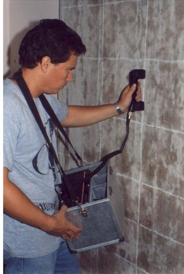
Ensayo no destructivo: detección de la posición de armaduras de acero por método magnético
